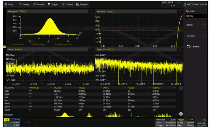
对数字信号进行眼图和抖动分析，自动从串行数据中提取时钟用于重构眼图和进行抖动计算；支持多种眼图和抖动参数的自动测量；支持对眼图的模板测试
