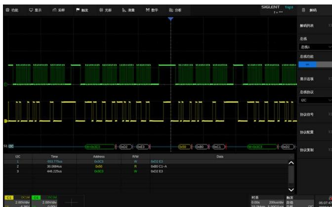
通过事件列表显示解码, 能快速、直观地将总线的协议信息以表格形式显示。支持 I2C、SPI、UART、CAN、LIN、CAN FD、FlexRay、I2S、MIL-STD-1553B、SENT、Manchester 和 ARINC429 等多种协议
