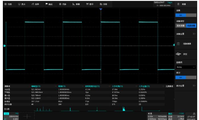
参数统计功能可显示任意参数的五种测量值：当前值、平均值、最小值、最大值、标准差；可同时测量统计 12 种不同的参数。直方图统计可以直观地显示参数的概率分布情况；趋势图和轨迹图可反应参数随时间的变化规律。
