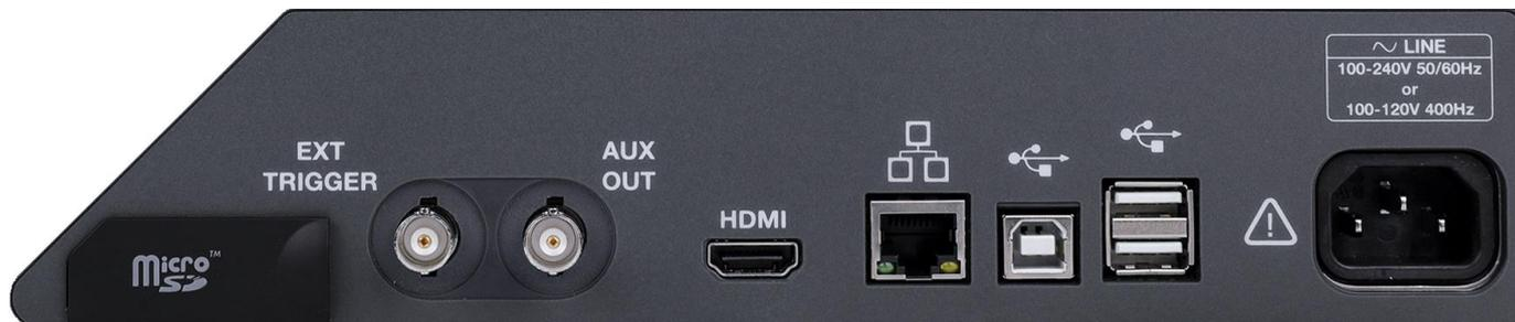
支持 2 个 USB Host 3.0 和 2 个 USB Host 2.0、1 个 USB Device 2.0 (USBTMC)、1 个 LAN (VXI-11/Telnet/Socket)、1 个 micro SD 卡、1 个辅助输出 (Pass/Fail 和 Trigger Out 复用) 和 1 个 HDMI 视频输出接口; 8 通道型号还支持 10MHz 参考时钟输入/输出
