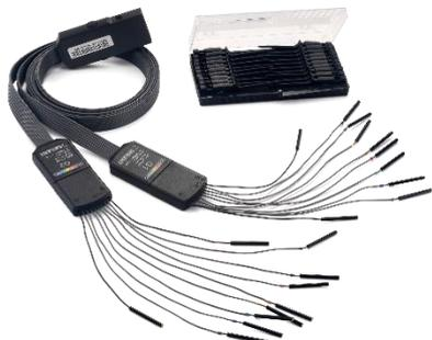
使用 16 路逻辑分析仪探头 SPL2016，可实现 16 路数字通道采集功能。数字通道与模拟通道结合，以实现混合信号采集与分析功能
